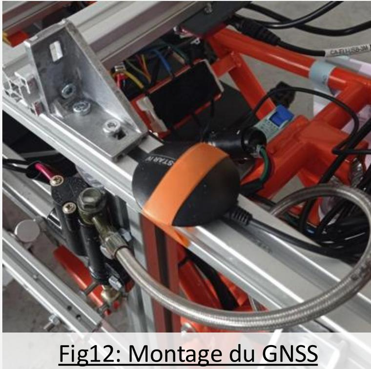
Fig12: Montage du GNSS
