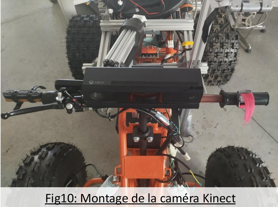
Fig10: Montage de la caméra Kinect
